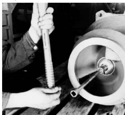
Рис. 9.3. Монтаж рабочего колеса с помощью динамометрического ключа
