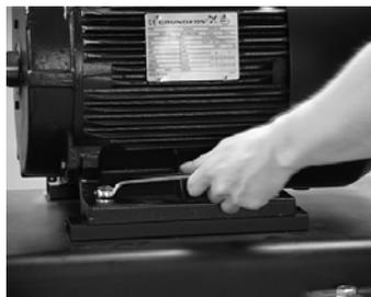
Откорректируйте положение электродвигателя. Ослабьте винты, крепящие двигатель.
