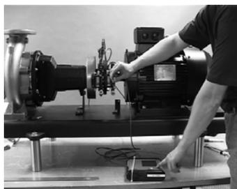
Поверните лазерные измерители в положение "9 часов".
