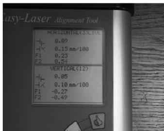
Если измеренные значения меньше 0,1 мм, регулировка взаимного положения насоса и двигателя завершена. Переходите к пункту 24.
